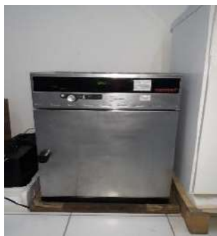
Oven mengukur MLSS secara gravimetri
