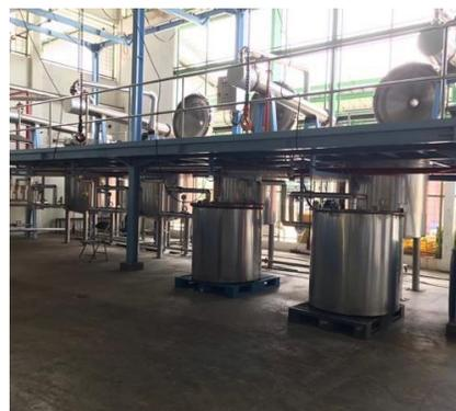
**Gambar 7.5. Rangkaian Alat Sistem Destilasi Minyak**
